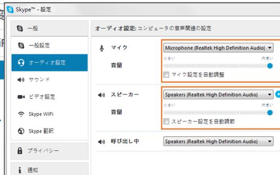
オーディオ設定が正しくセットアップする。ご利用の装置（付属や内蔵）をスイッチし、自動音声調節機能をキャンセルして音量を最大までにします。
